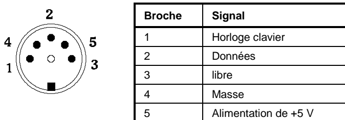
Fig. 8-9 Brochage de la prise KEYBOARD
